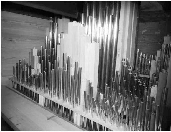
Blick in das Innenleben der Orgel: Metall- und Holz- pfeifen des Manuals
