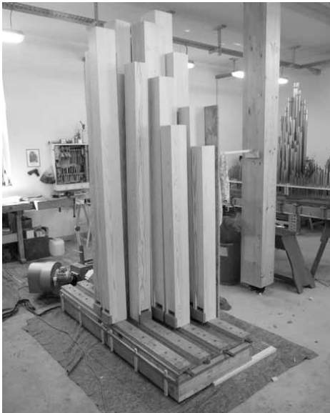
Probeweise Aufstellung der Pfeifen auf den Windladen in der Orgelwerkstatt
